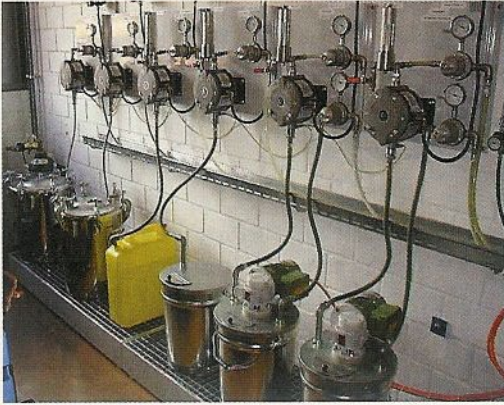
Versorgung der Standardkomponenten bei Pilatus. Sonderfarben mischt man nach den Vorgaben des Systems auf der integrierten Waage genauso exakt ab.
